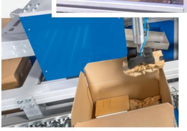
3. THE PROCESS OF INSERTING PROTECTIVE PACKAGING INTO THE BOX IS FULLY AUTOMATED
